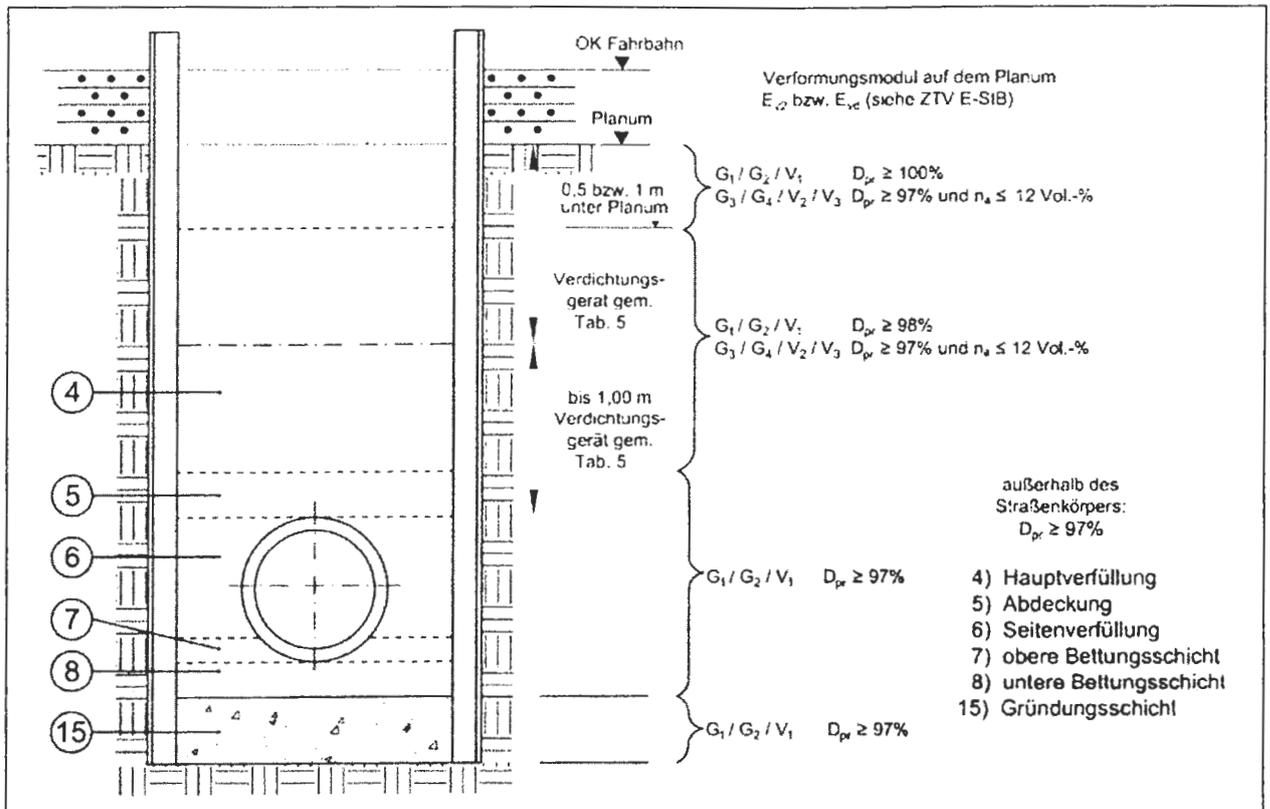
Danach sind die örtlichen Böden der Gruppen G1 - G3 für den Wiedereinbau in der *Verfüllzone/Hauptverfüllung* geeignet, jedoch sind Böden der Gruppe G3 (lehmige Verwitterungsdecke) nur bei annähernd optimalem Wassergehalt auf die geforderte Proctordichte zu bringen. Dies ist i.d.R. nur durch Beimischung von hydraulischem Bindemittel möglich, so dass der Wiedereinbau der lehmigen Böden der Gruppe G3 (= Homogenbereich B1) unter Verkehrsflächen nicht empfohlen wird.
