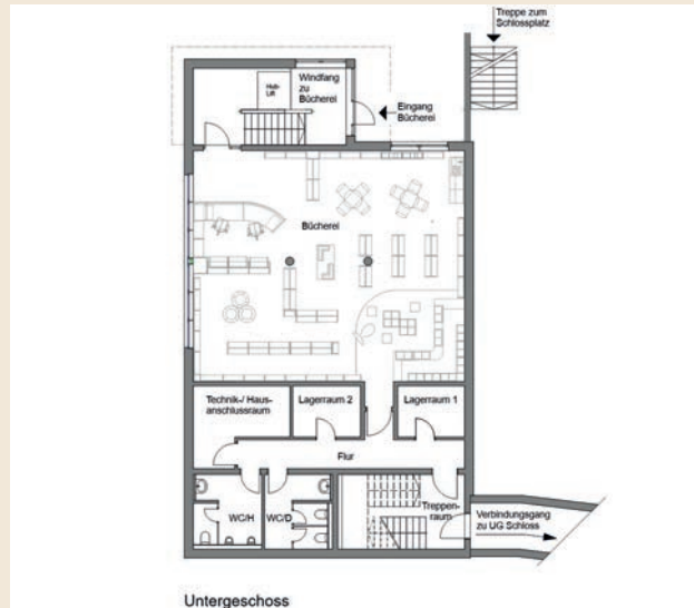
Plan vom Untergeschoss des Mehrzweckgebäudes [10]
